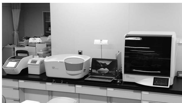
図 1 QX200 AutoDG Droplet Digital PCR システム (設置場所: 中央研究施設・日高ランチ機能部門 607 実験室)。
