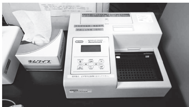
図2. 一般的な簡易型プレートリーダー
